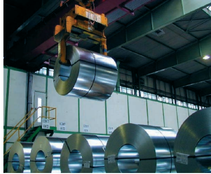
Bild 5: Lagerung und Transport von Coils Die Überfahrhöhe zwischen angeschlagener Last und lagernden Einheiten muß mindestens 500 mm betragen.
